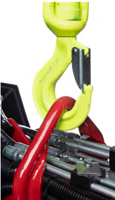
Figuur 7.3 Lifting point on boom
