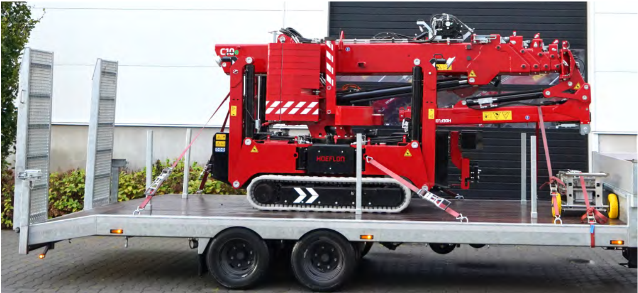
Figuur 7.2 Securing crane
